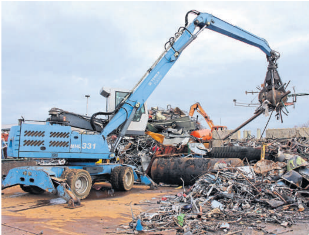
Der Bagger ist beim Recyclingunternehmen Bana ein wichtiges Hilfsmittel bei der Sortierung und Bewegung des angelieferten Metallschrotts.
